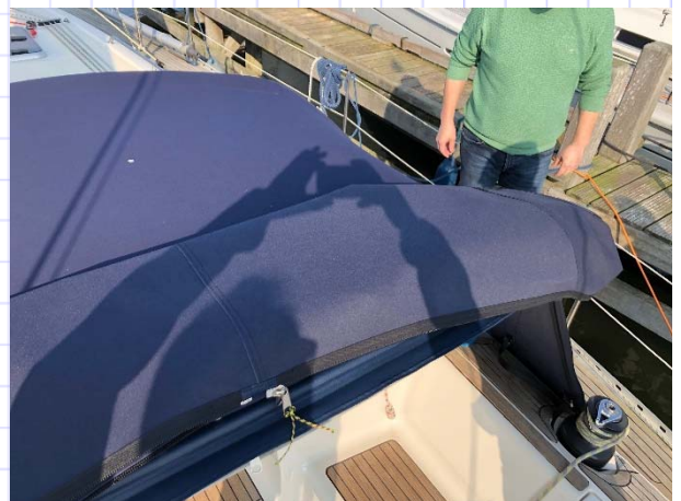
7. Reißverschluss zur Sprayhood trennen.
