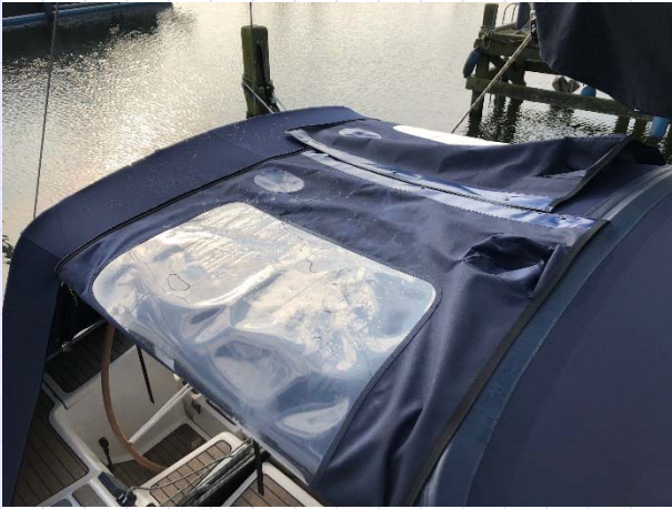
2. Seitenfenster öffnen und Dach umschlagen
