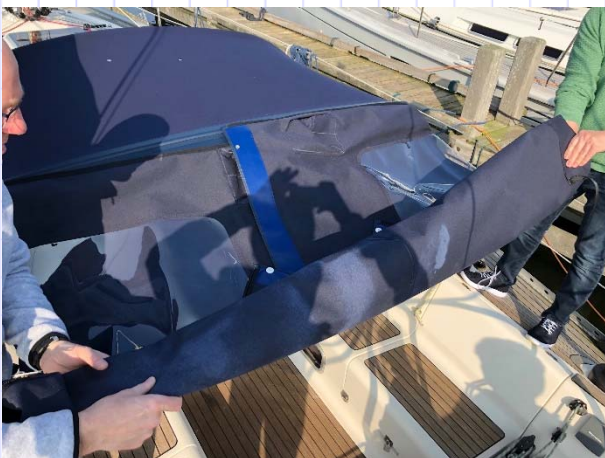
6. Kuchenbude nach vorne aufrollen und auf Sprayhood ablegen. Harte Knicke vermeiden.
